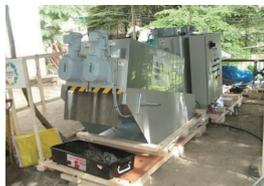
自動連続運転が可能、といった特徴を有しており、現在までに世界 58 개국に 2,112 台（2014 年 1 月現在）の納入実績がある。セブ市で未処理となっている浄化槽汚泥をヴァールト脱水機で処理する事により、河川に放流可能なレベル(BOD200mg/L 以下)まで浄化槽汚泥を処理し、固液分離の過程で生じる脱水ケーキをコンポスト（肥料）として再利用する。このフローにてセブ市で現地実証実験を実施（2013 年 1 月）、ヴァールト脱水機による浄化槽汚泥の処理が可能であることを証明した。実証試験中はセブ市長をはじめ、廃棄物管理委員会の主要な関係者、市議会議員、水道局、更にはセプティッジ管理の主幹官庁である保険省、民間企業からはマニラの上下水道を管轄しているマニラウォーター社（Manila Water Company Inc）、マニラッド水道事業会社（Maynilad Services Inc）両社の関係者が見学に訪れ、ヴァールト脱水機の有効性を実感してもらった。
