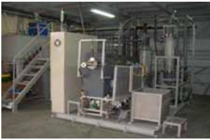
図-3 フロン破壊装置
